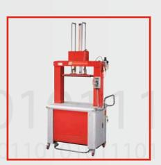
MP-702 für 5-9mm PP-Band mit Standardrahmen 650 x 500 mm und Doppelpresse
